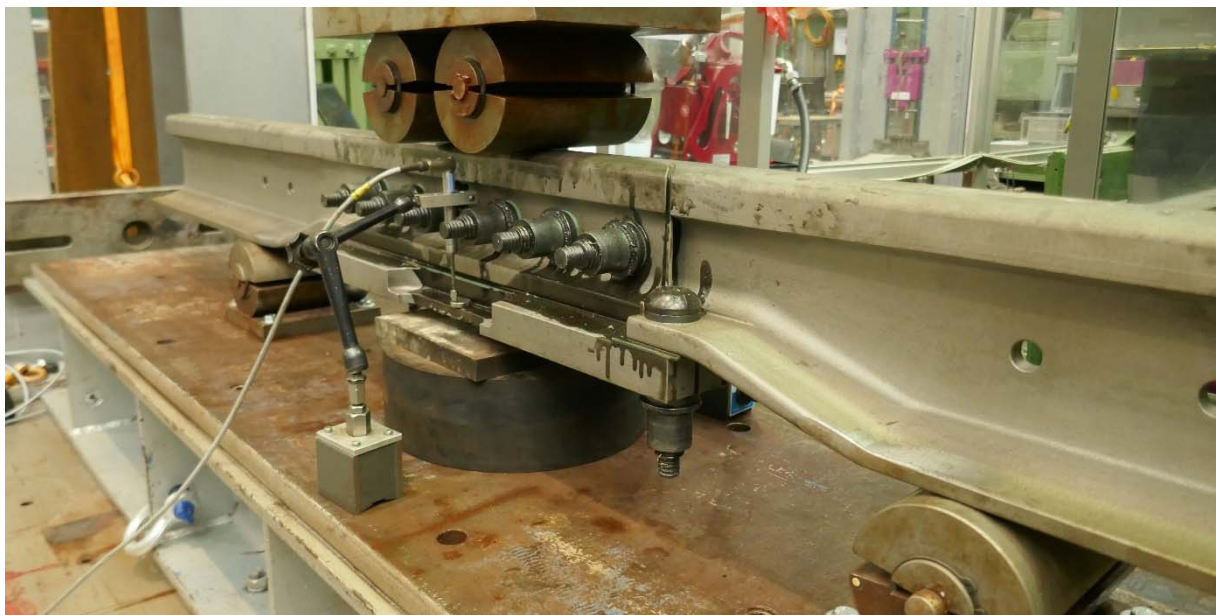
Abbildung 4: Probe ABJ-009 im Prüfaufbau der Biegewiederholprüfung
